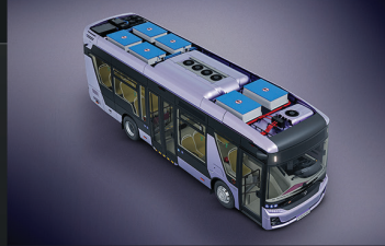
8x48 kWh TemsaTech Batarya Modülleri 600 km Menzil
